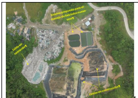
Construcción de nuevo vaso de disposición final en el botadero Marmolejo. Lugar: Botadero a cielo abierto Marmolejo. Fecha 16/05/2023
